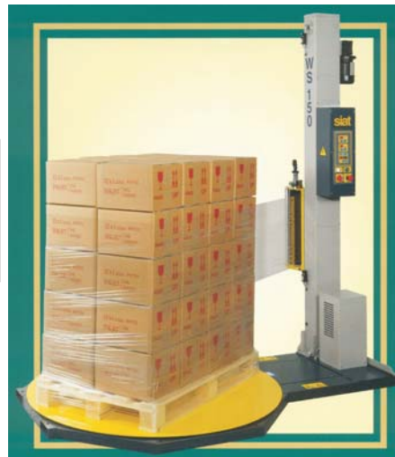
Automatische Stretchanlage Modell WS 150-A , mit Fotozelle für die Palettenhöhenabtastung, 1 Wickel- programm, Elektron.Drehzahlregelung des Drehtellers Federbremse für Folienspannung, Sanftanlauf, Fix- stop und Auffahrrampe
